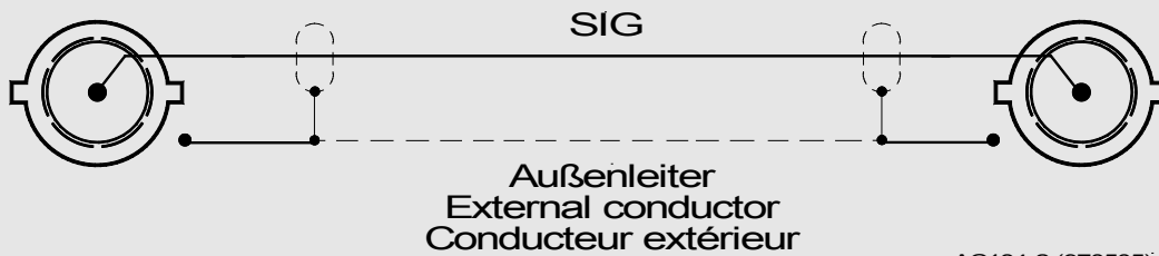
Anschlussplan des Verbindungskabels AC-184 Connection diagram of connecting cable AC-184 Schéma de connexion du câble de liaison AC-184
