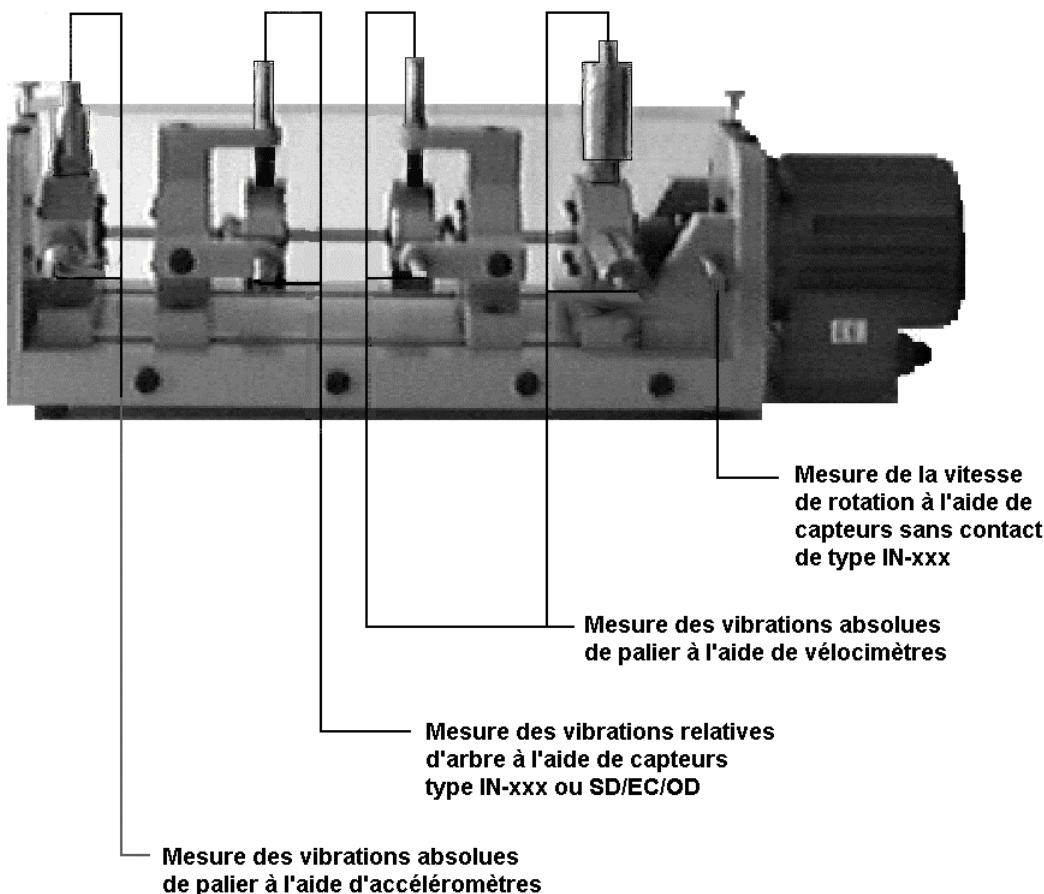
Ce rotor-modèle simule les vibrations de machines réelles. Il permet d'acquérir un bon entraînement à l'acquisition des mesures de ces vibrations. Il est très compact et facilement transportable. Il répond aux exigences des normes actuelles de sécurité (CE).
