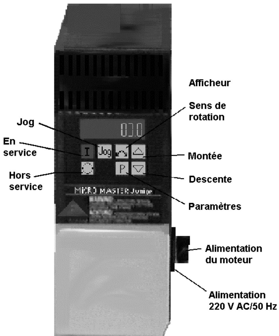
L'unité de pilotage (**Micro Master Junior**) est alimentée en 220 V AC 50 Hz. Elle assure l'alimentation et la régulation du moteur du rotor-modèle.
